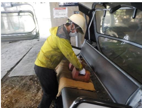
(6) 各索道の定期検査を実施し索道事業の再開届出書を運輸局に提出致しました（荷重制動試験中）
