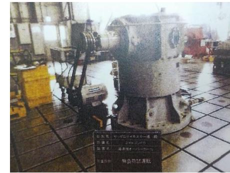
(上段：原動滑車取外し、上段：減速機試運転)
