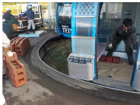
(6) 各索道の定期検査を実施し索道事業の再開届出書を運輸局に提出致しました（荷重制動試験中）
